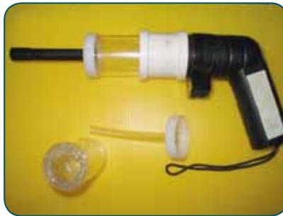
Figura 9 – Capturador elétrico de sucção (aspirador) pequeno
