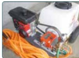
Figura 20.2 – Moto pulverizador 130l
