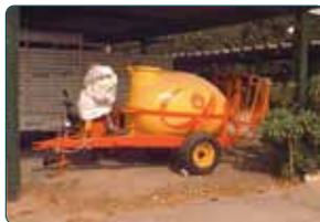
Figura 20.1 – Pulverizador de 2.000l
