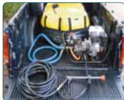
Figura 20 – Pulverizador com tanque flexível
